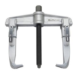
BATO Abzug 130x100mm. 2-armig mit Metall-Clip-Verschluss zur Quick Justierung. Abzug kann innen 50-130mm und außen 90-170mm.
